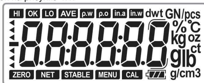
Рис. 4.1 – Внешний вид дисплея весов XE
