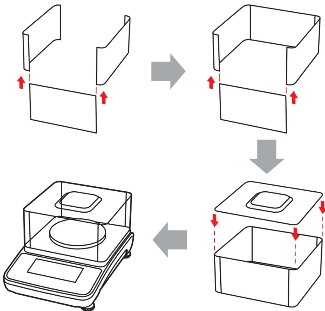
Рис. 4.5 – Сборка и установка ветрозащитного кожуха
