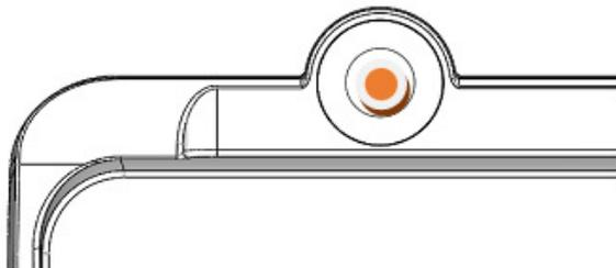
Рис. 4.4 – Местонахождение индикатора горизонтального уровня установки весов
